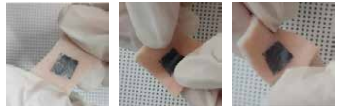
그림 4. Stretching, bending, twisting of the tattoo-attached pigskins.
