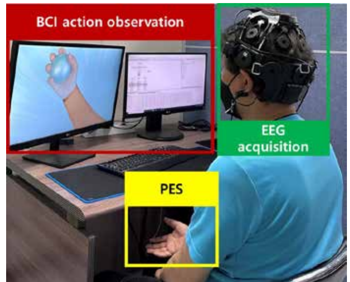
그림 1. PES를 결합한 BCI 기반의 집중 피드백 동작관찰 재활 시스템
