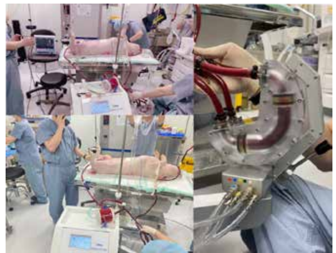
그림 2. 박동형 체외막산화기 전임상실험 및 혈액펌프 구성
