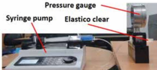
그림 3. Leak pressure test 실험 구성
