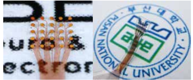
그림 3. 완성된 COC 신경전극의 사진
