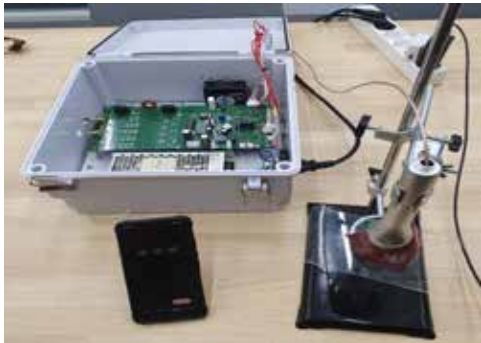
그림 2. 간 조직을 이용한 변성 특성 평가 셋업
