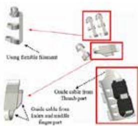
그림 2. 3D 프린팅 손 보조기의 각 부분의 구성
