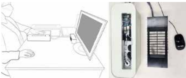
그림 1. (좌) 실험 환경 및 (우) 맞춤형 열 그릴 장치
